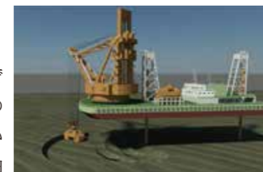
▲海底・川底の土砂を掘削する「浚渫」
