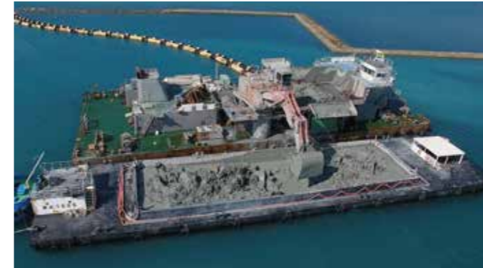
▲圧縮空気のみで土砂を送る「空気圧送船」
