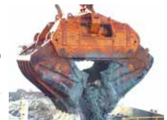
▲200立方メートルの巨大グラブバケット
