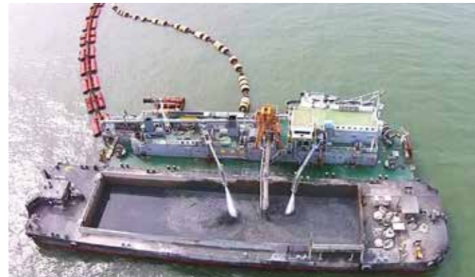
▲ポンプで土砂を送る「バージアンローダー船」
